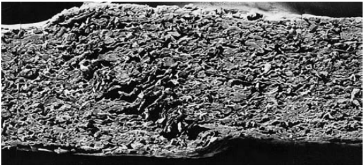
Slika 11: Primer razplastitve zaradi tlačne obremenitve.
