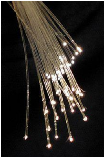
Slika. Prikaz in princip delovanja optičnega vodnika, ki deluje na osnovi popolnega odboja svetlobe http://en.wikipedia.org/wiki/Optical_fiber ,
