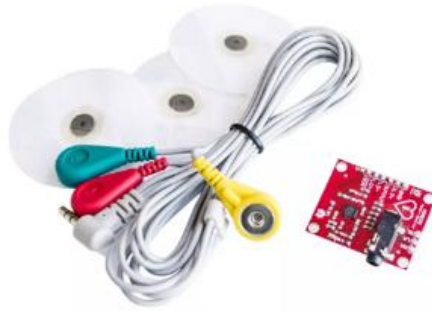
Slika. Instrumentacijski ojačevalnik s kablom in elektrodami za EKG. Ojačevalnik je narejen na osnovi AD8232.
