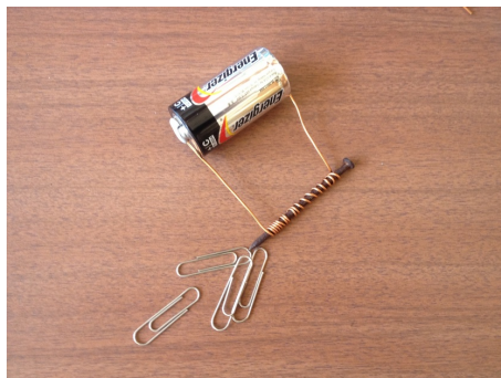
Slika 15.2: Izdelava preprostega elektromagneta.
