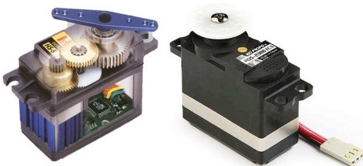
Slika 8.1: Prmer modelarskega servomotorja
