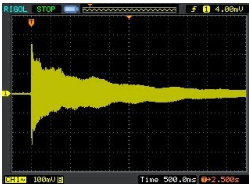
Slika 11.1: Primer izhodnega napetostnega signala električne kitare pri zaigrani "struni A".
