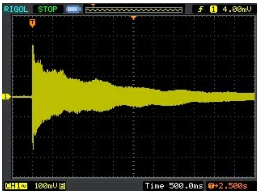
Slika 1: Primer izhodnega napetostnega signala električne kitare pri zaigrani "struni A".
